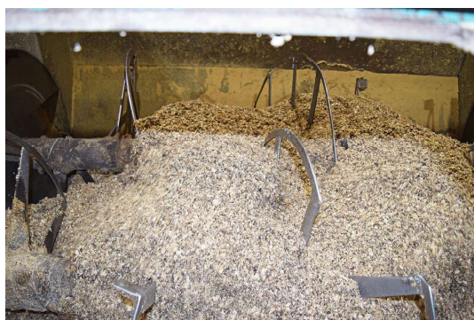
破砕後の食品廃棄物に種菌とおがくずを加えて攪拌
