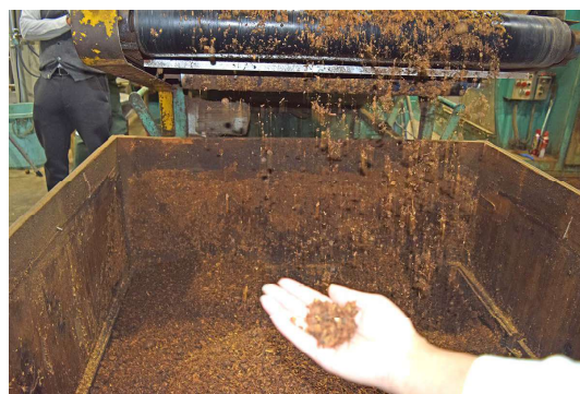
バイオドラム(発酵機)で一次発酵
