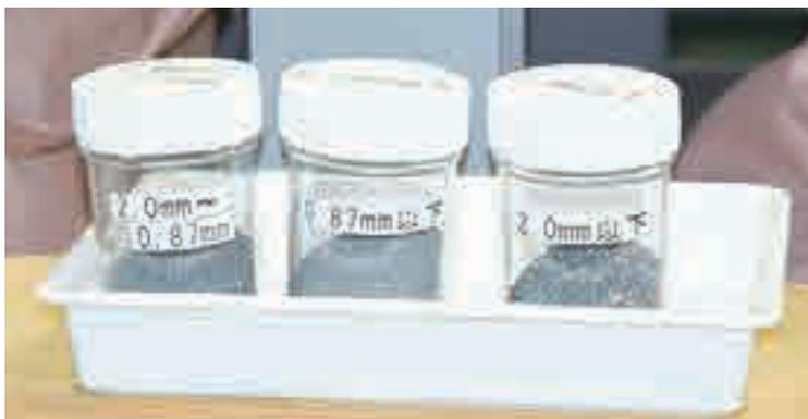
(写真2) 銀を回収するためにセルシートを0.87mm以下まで粉砕
