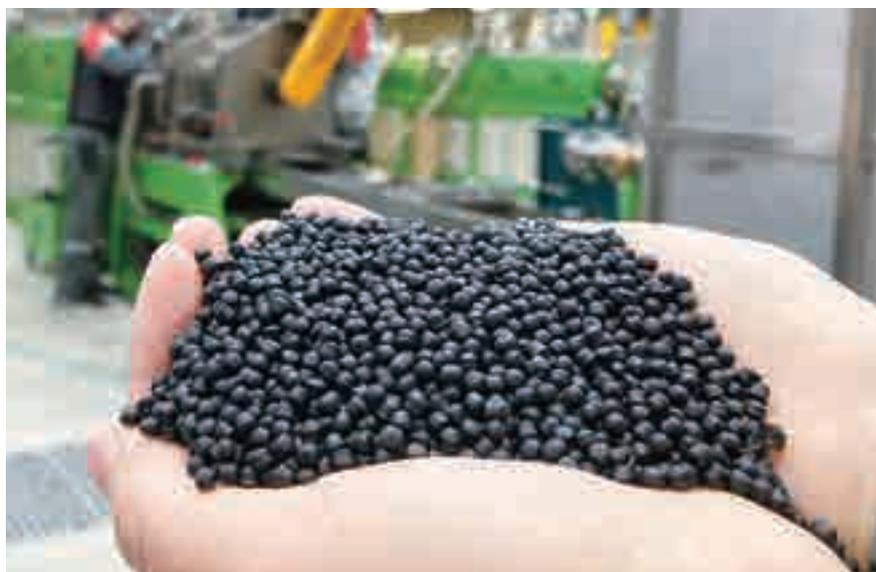
軽液・重液・静電選別の後、ポリプロピレン（PP）、ポリエチレン（PE）、ポリスチレン（PS）、ABSをフレークやペレットに加工されたものは、プラスチック製品や部品メーカーの品質要求に合わせて、原料を選定、調合して再生プラスチックを製造し、最終的には、自動車や電気製品の部品、日用品、物流資材などに使用されることとなります。
