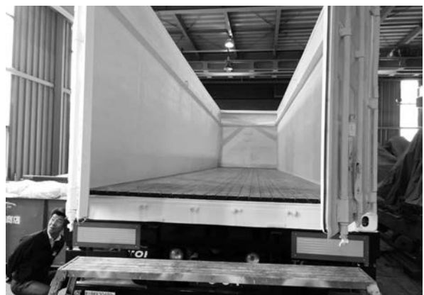
⑦前方に傾斜板を張り積載物が滑って荷降ろししやすいようにしている。
