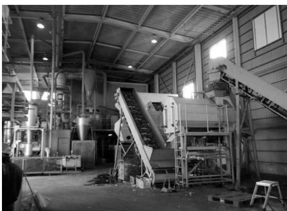
PETのラベル剥がし専用機
