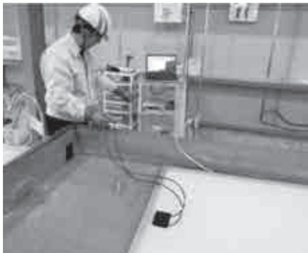
絶縁検査の参考写真(水槽を用いた絶縁抵抗検査の例)
