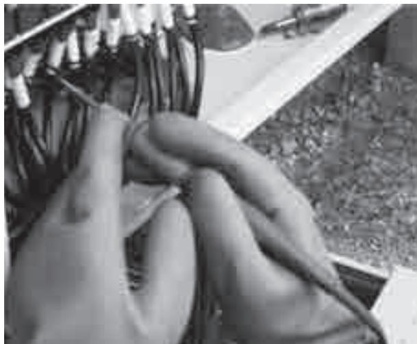
絶縁検査の参考写真(発生現場での絶縁抵抗検査の例)
