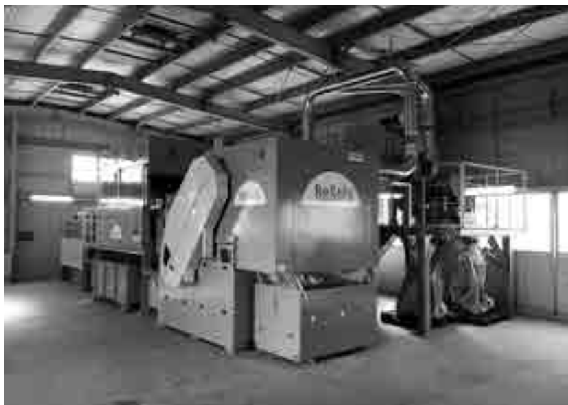
アルミ碎解体機とガラス剥離機が組み合わさった 太陽光パネルリサイクル装置「ReSola」
