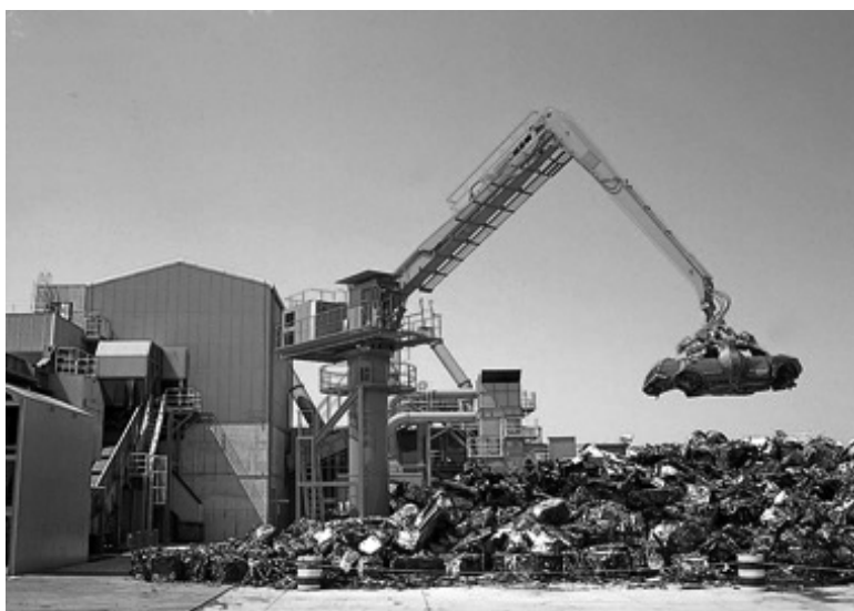
破碎選別処理設備 シュレッダーマシン （共英製鋼ホームページより）
