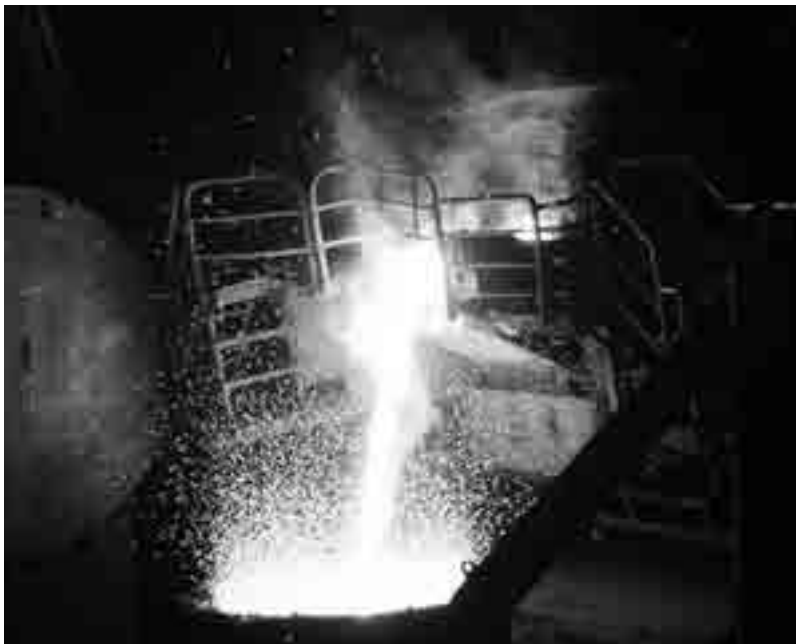
鉄スクラップと廃棄物を電気炉で溶融する
