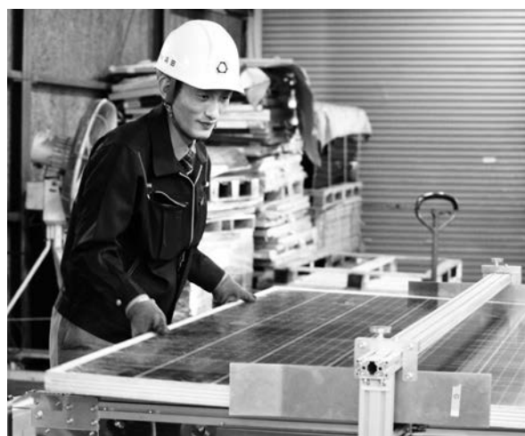
② コンベアに太陽光パネルを設置
