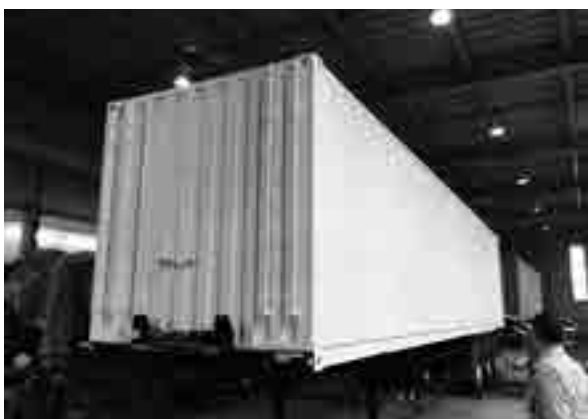
⑤外装だけ完成した改造コンテナ(40フィート)。
