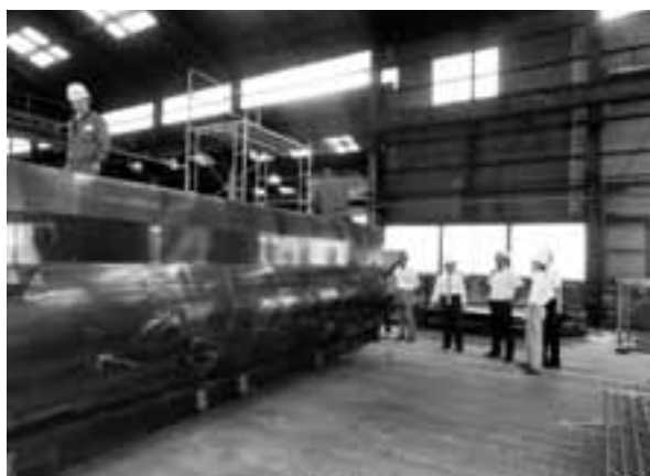
アルマジロロトライニング加工完成品
