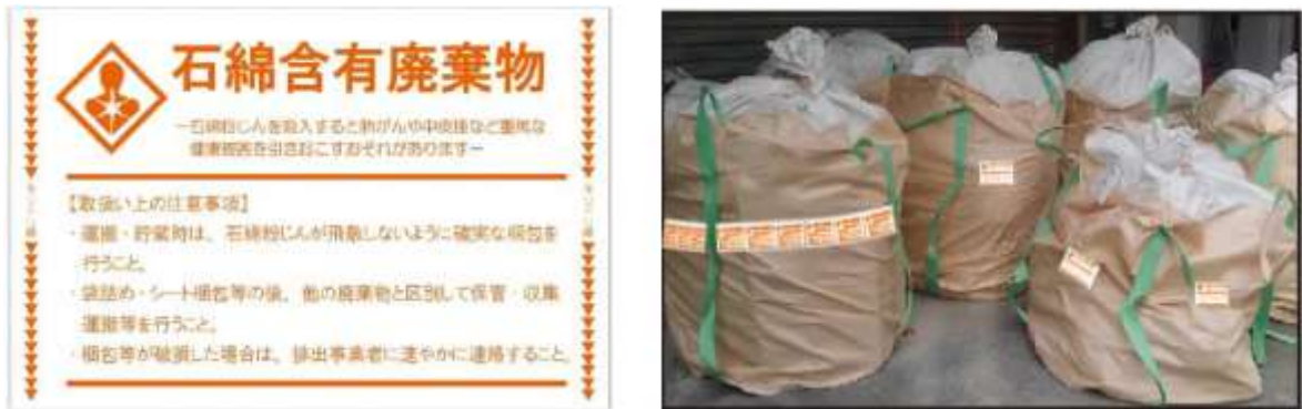
図3-7 石綿含有産業廃棄物の表示テープ
