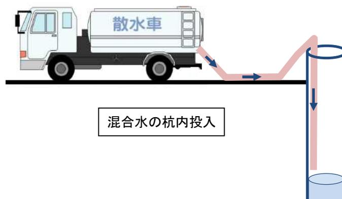
図 3-8 混合水の杭内投入
