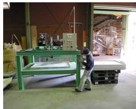
図表 30 アルミフレーム枠外し機
