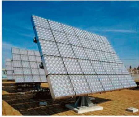
図表 14 集光型太陽光発電システム例
