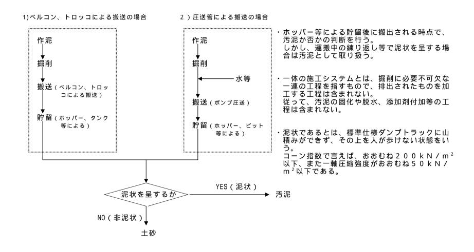
泥土圧シールド工法(泥土圧推進工法等)
