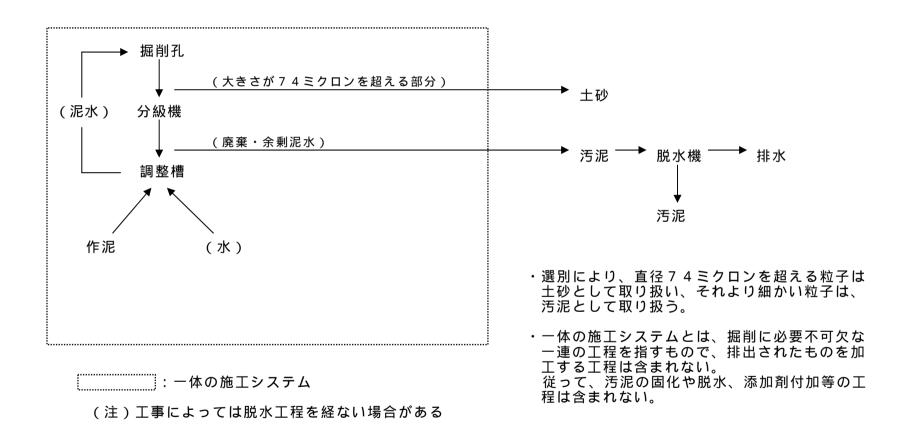
泥水シールド工法(リバースサーキュレーション工法、泥水推進工法等)
