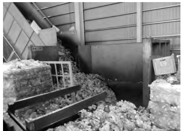
PETボトルのプラントの投入口
